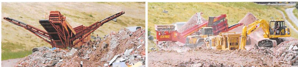
ნახ. 82: სამშენებლო და ნგრევის ნარჩენების მობილური საცრელი დანადგარი (CDW) 115
